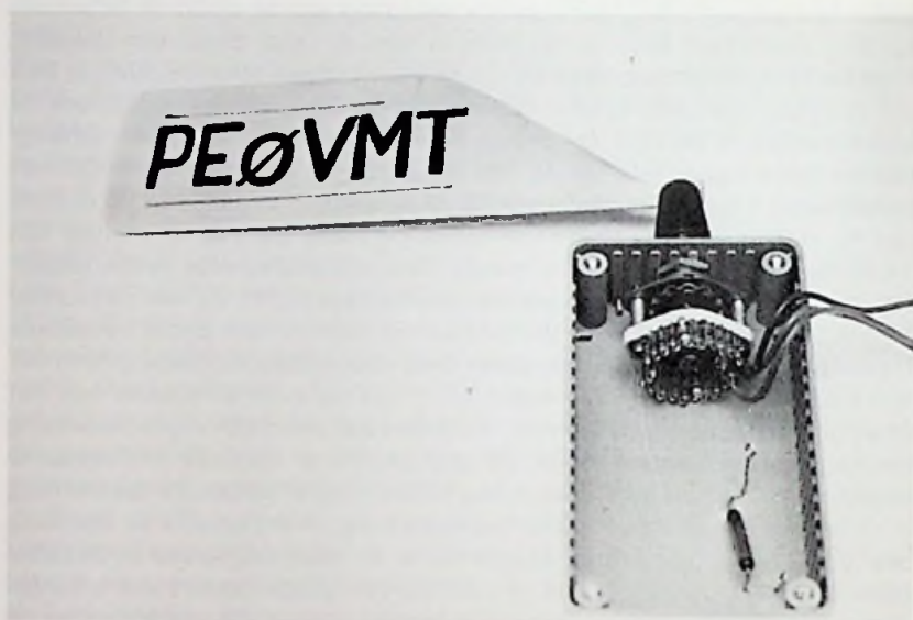
Afb. 4.38: Het kastje met de windvaan. Op de schakelaar zijn de weerstanden gemonteerd
