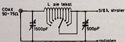
Afb. 3.2: Een achterstevoren geschakeld Pi-filter kan goede diensten bewijzen om een straler aan te passen op lagere frequenties
