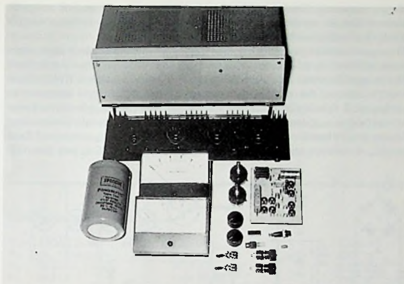
Afb. 4.10: Met deze spullen kunnen we een regelbare gestabiliseerde voeding maken. De transformator en de bruggelijkrichter ontbreken op de foto
