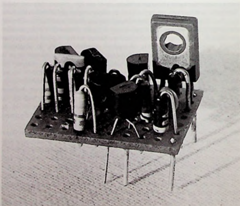
Afb. 4.44: Een morse-regenerator kan klein zijn. Het hier getoonde model is opgebouwd op een stukje montaprint van 25 x 20 mm
